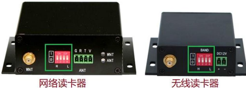
将网络读卡器连接好定位天线后，设备上电。观察“ANT”指示灯是否闪烁，如果有闪烁，则对应的读卡天线探测到了标签。
