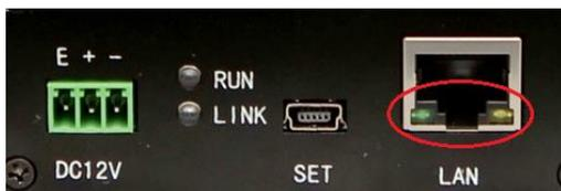
设置好读卡器的 IP 地址，在电脑上打开命令行窗口，PING 这个地址，测试读卡器设备是否网络可达。
