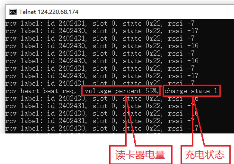
在打印信息中，我们可以看到读卡器和测试软件的握手消息，握手消息中有读卡器的剩余电量、充电状态等信息。
