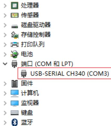
如果电脑无法识别该 USB 串口设备，则需要安装相应的驱动程序。
