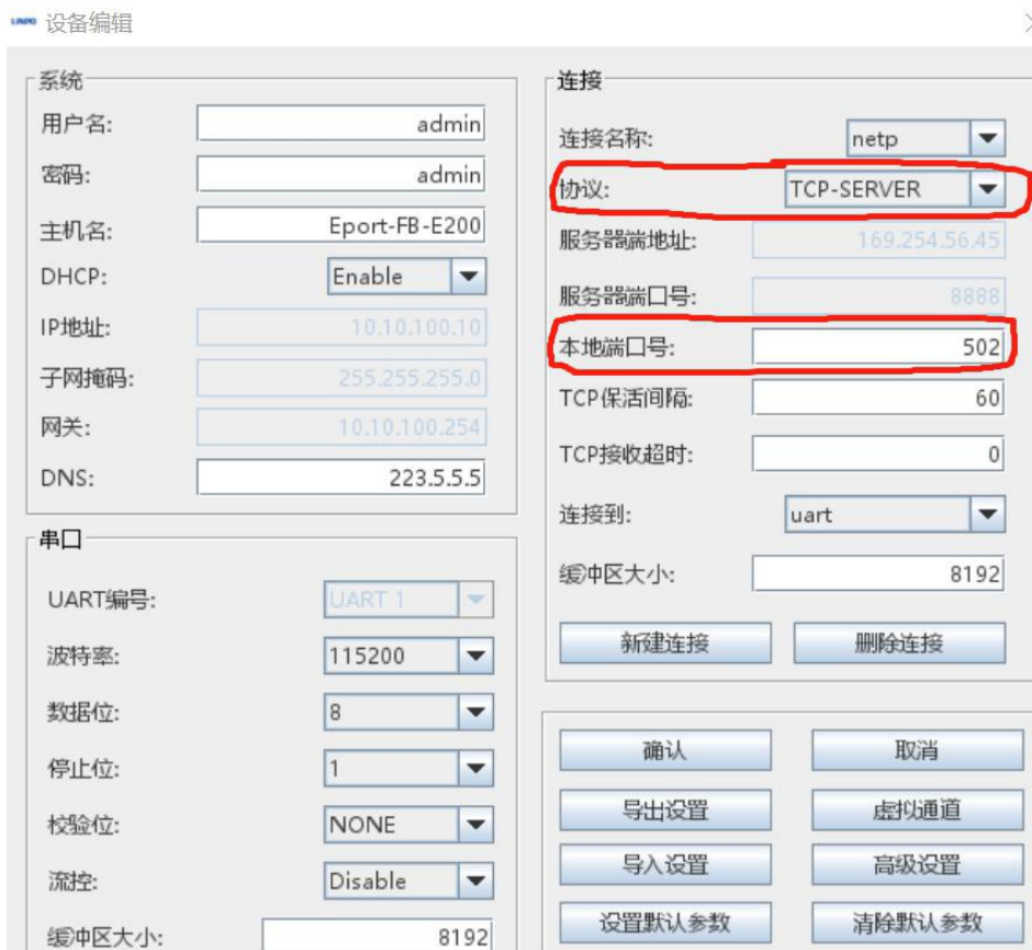
Figure 74. Modbus RTU 的测试设置
