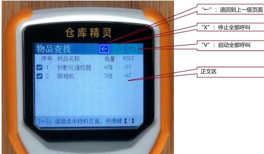
在这个页面中，手持机会自动呼叫页面中显示的所有物品的电子标签。你也可以看到每个物品的电子标签的电量和信号强度（RSSI 值），通过 RSSI 值可以大概估算电子标签离开手持机的距离远近。
