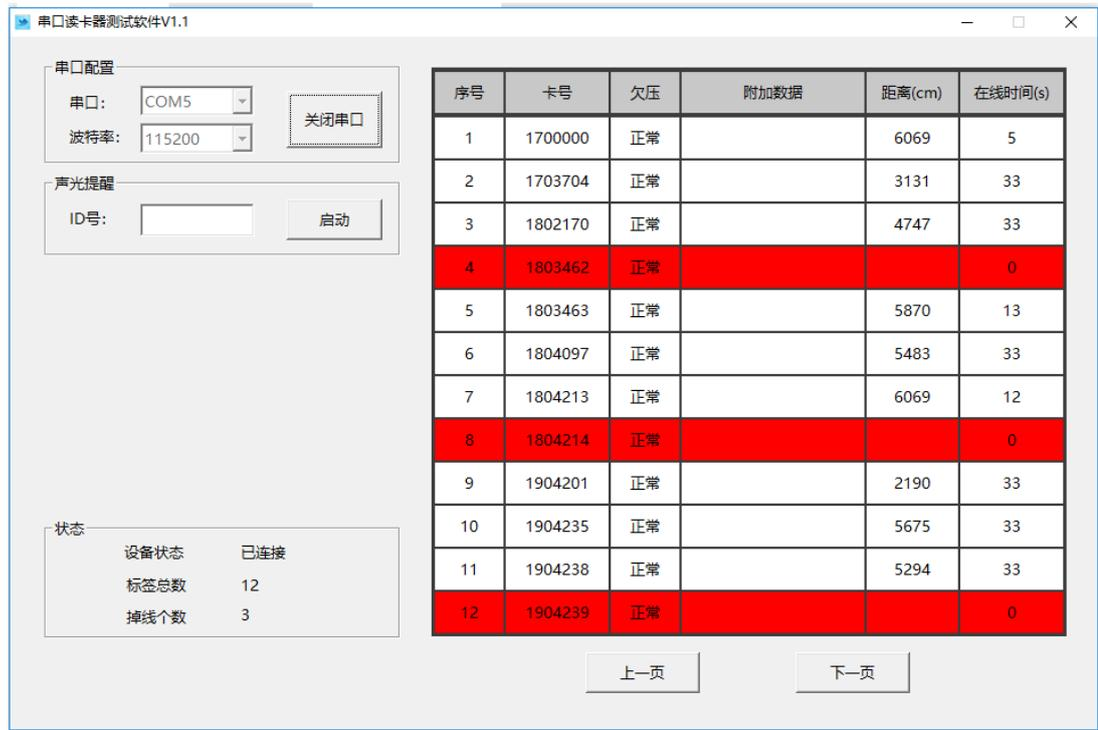
选择读卡天线连接的串口，选择 115200bps 波特率，然后启动测试即可。
