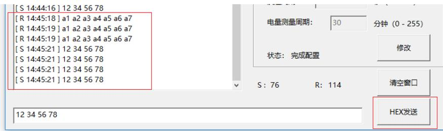
停止发送数据一段时间后，会退出数据透传状态，“数据”灯熄灭，恢复读卡功能。
